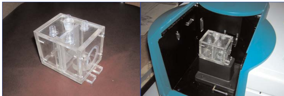
Фото 2. Бокс-камера контроля диффузии атмосферного кислорода и воды, выполняемого на спектрофлуориметре Varian Eclipse. Сконструирована под руководством А. К. Чибисова.
